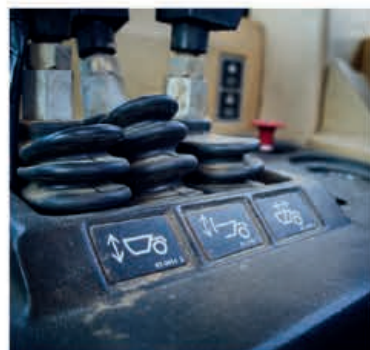
Piktogramy slouží k rychlé identifikaci základních úkonů skrejpru
