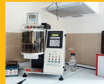
Viskozimetr měří viskozitu oleje. Změny značí závadu či degradaci
