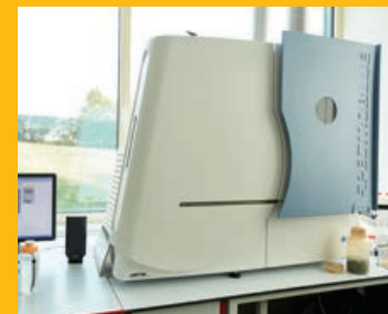
Optický spektrometr měří otěrové a aditivační prvky a kontaminanty
