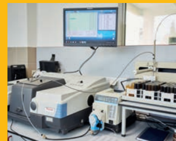
Infračervený spektrometr určuje stupeň zestárnutí oleje
