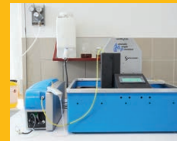
Čistotu oleje ze vzorku prozradí laserový čítač částí
